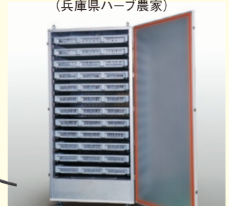
熱源 熱風発生機 1台 処理量 30kg
