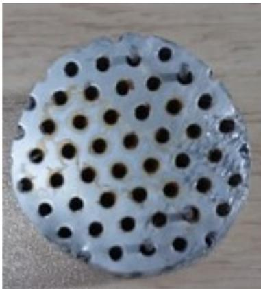
図 7: 積層アルミパンチング正面
