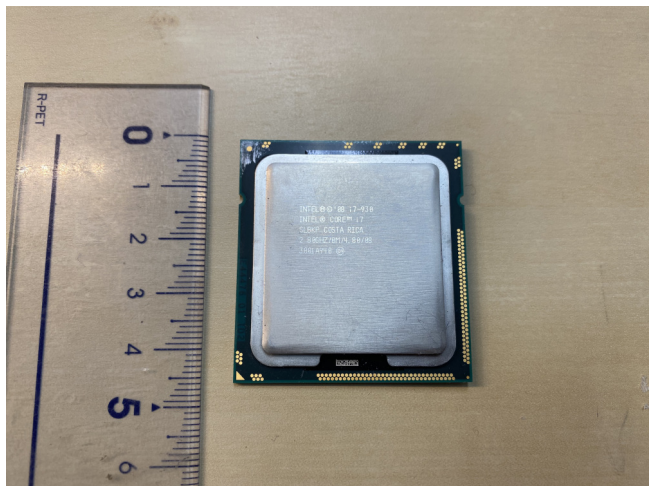
図 1: CPU. コンピュータの頭脳にあたる部品であり、ほぼすべてのパソコンに搭載されている。GPU に比べて複雑な計算を行うことができる。
