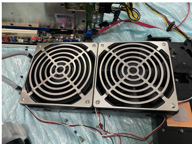
図 8: 冷却水の冷却を行うラジエータ。ファンが2つあり、片方のみ止めることも可能。
