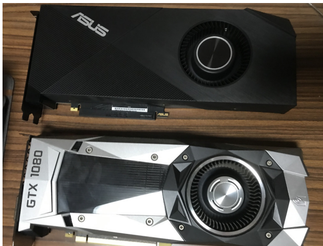
図 2: グラフィックボード. この中に GPU が搭載されている。3D ゲームなどの高度な描画に使われる単純な計算を高速に行え、近年では汎用的な計算にも使われている。
