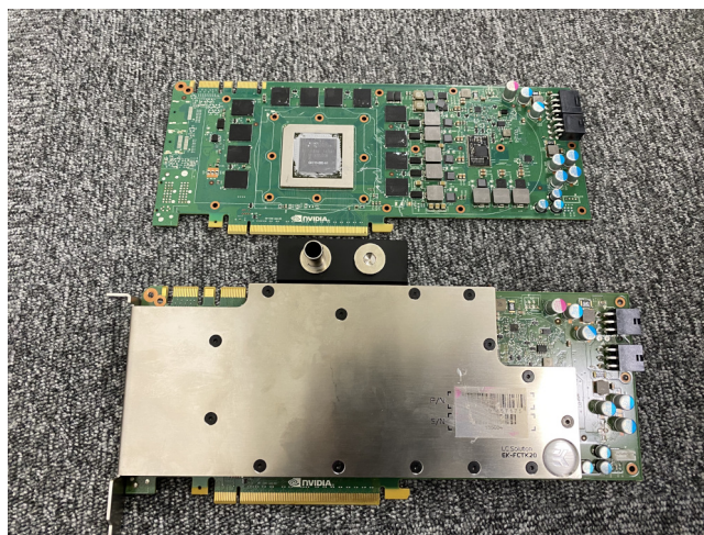
図 7: 熱交換モジュールをつける前のグラフィックボード（上）とつけた後のグラフィックボード（下）
