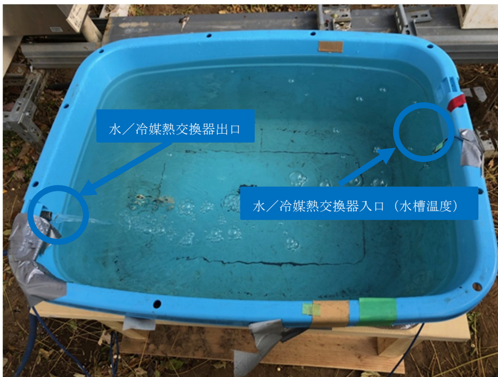
Fig. 14 水/冷媒熱交換器入口・出口熱電対取り付け位置
