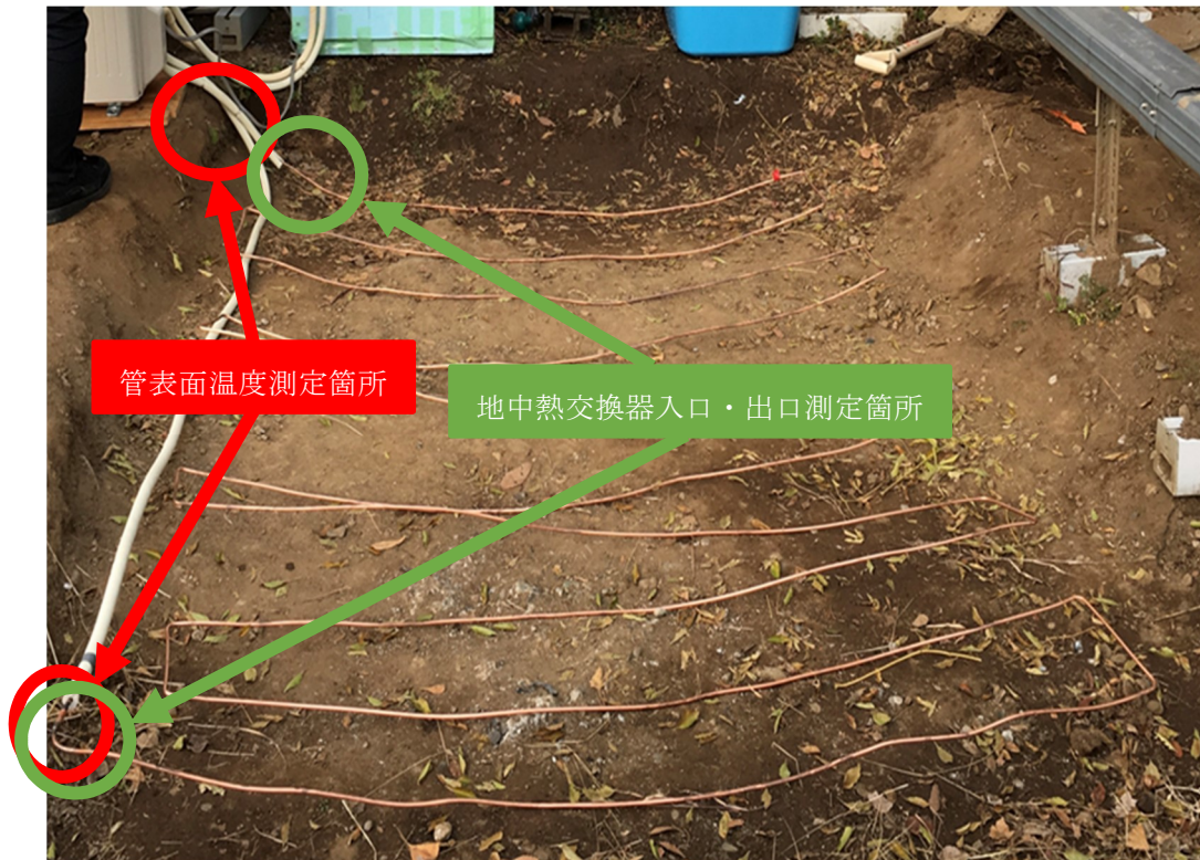
Fig. 13 地中熱交換器入口・出口，管表面熱電対取り付け位置
