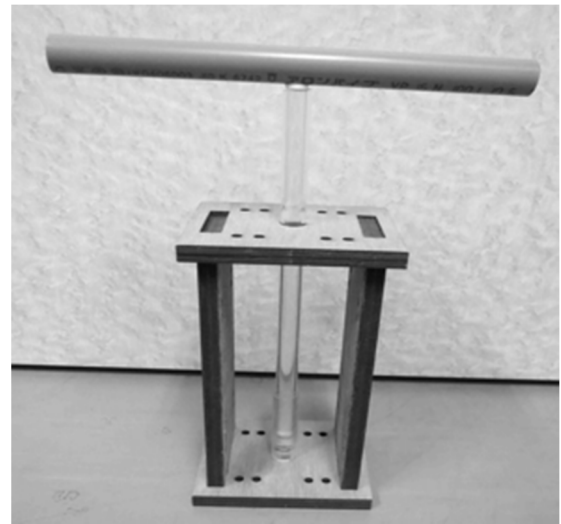
図3 圧気発火器の外観写真
