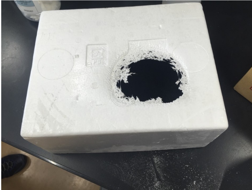
写真 2-2 発泡スチロールの容器が溶けた写真
