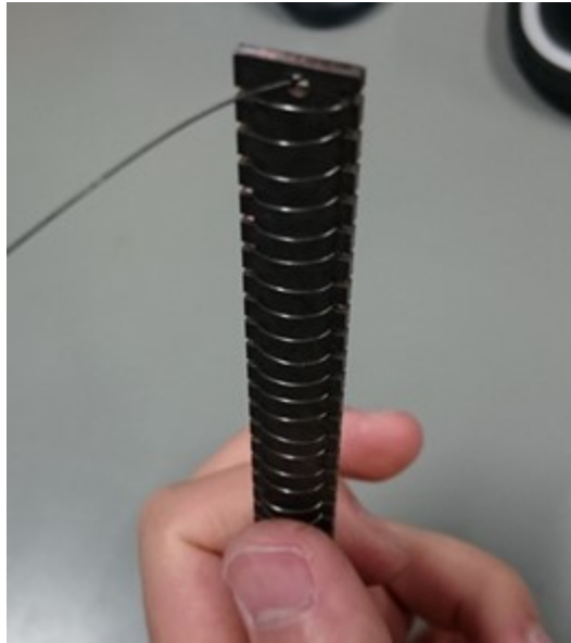
Fig.13 コイル状に固定した形状記憶合金
