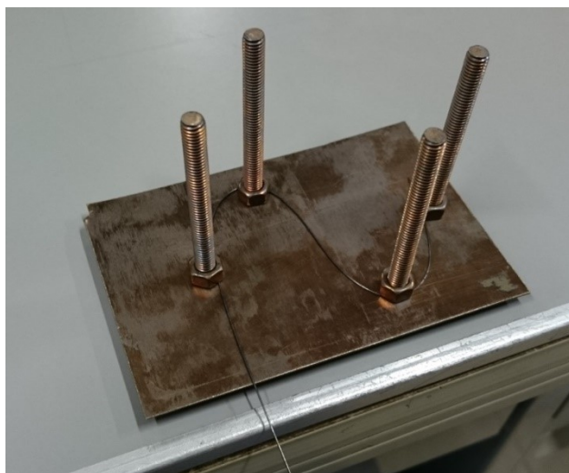
Fig.11 波状に固定した形状記憶合金(山が 2 つの場合)
