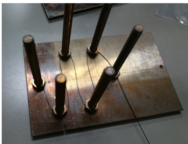
Fig.12 波状に固定した形状記憶合金(山が 4 つの場合)
