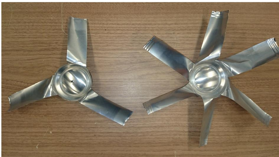
図 9: アルミ缶 (350ml) で製作したプロペラ
