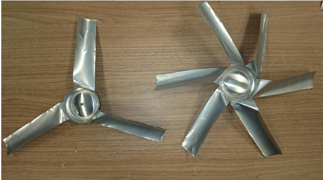
図 10: アルミ缶 (500ml) で製作したプロペラ
