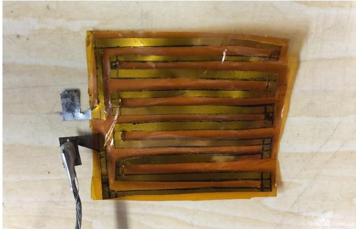
図 17 自作ステンレスヒータ
