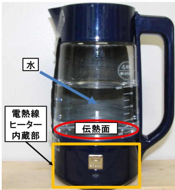
Fig. 1. 1. 1 本実験で使用する電気ケトル(定格 1kW)
