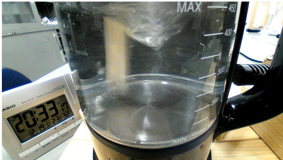
Fig. 4. 1. 1 旋回流を発生させる実験
