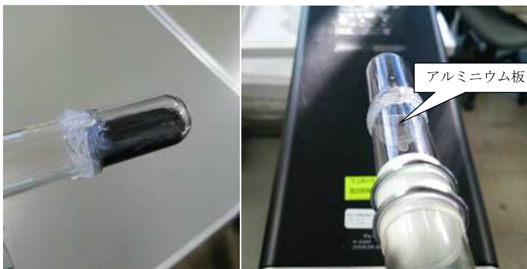
Fig. 18 試験管底部の加工
