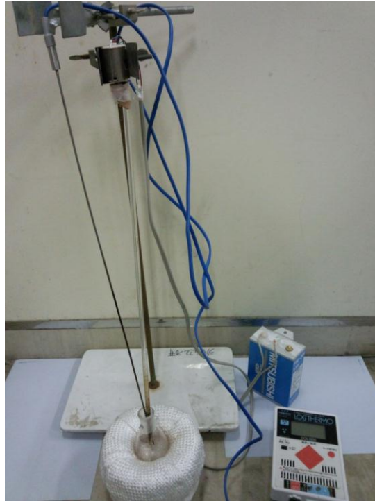
図13. ナス型フラスコ、攪拌装置等を組み立てた試作
