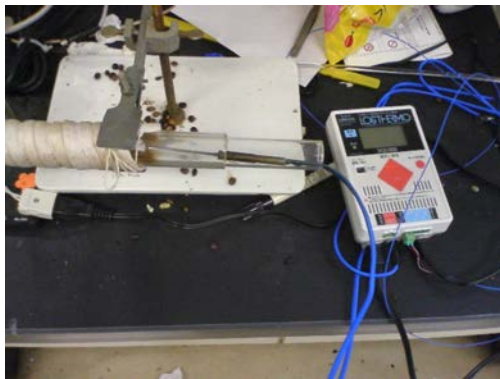
図 2. ログサーモを使用した焙煎装置
