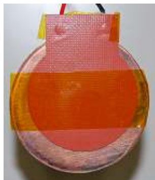
図 22. ヒーターを取付けた尾部底面
