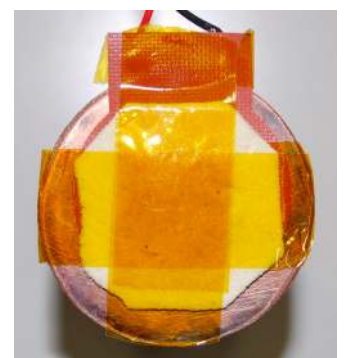
図 26. ヒーターの接地強化
