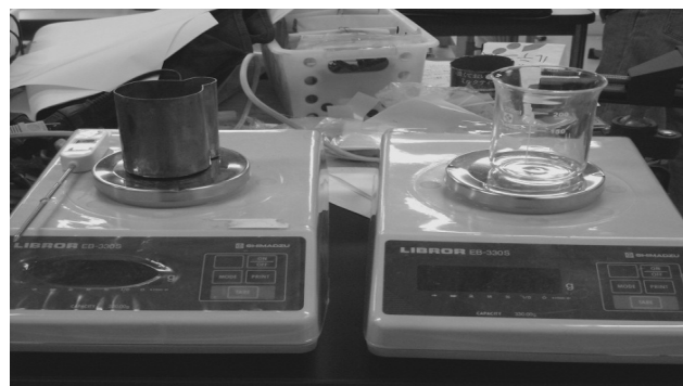
図9 実験の様子。左側が銅製の容器、右側が 200[ml]ビーカーである。今回の実験では、どちらの容器も電子天秤の上に載せ、質量変化と同時に湯の温度も測定した。使用した電子点天秤の感量は 330[g]である。
