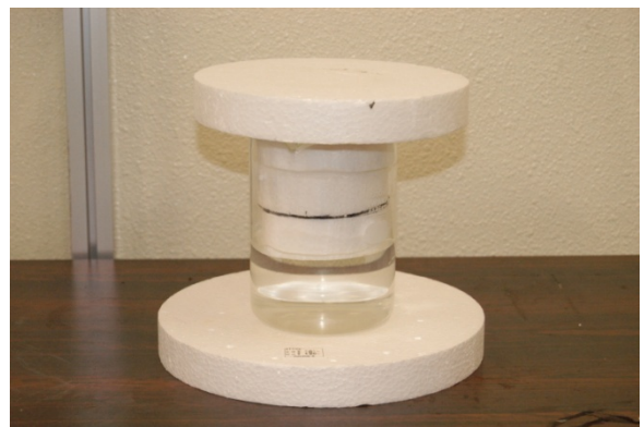
図4 上下を発泡スチロールの蓋をして密閉したビーカーの外観。上下の断熱と、ビーカー内部の空間の締め出しにより、気化の防止と系外への散逸を抑えることができる。
