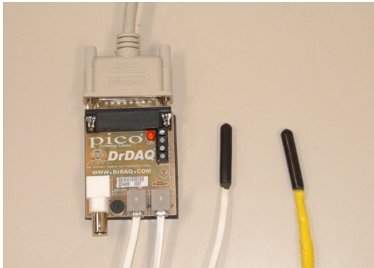
図1 pico Technology 社製 Dr.DAQ (パソコン計測アダプター)(気温を測定するセンサーは基盤の上に、水温を測定するセンサーは右の2個の黒い部分である。)
