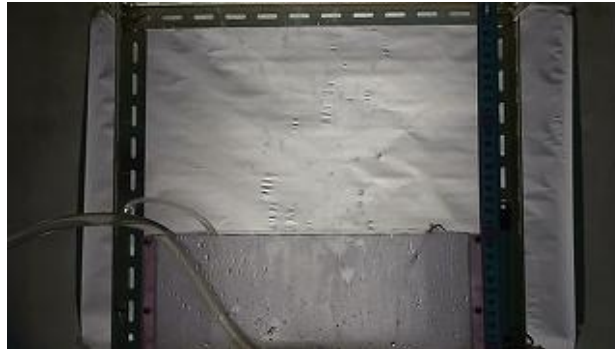
図 12 管径 11.6mm,蓄水位 20mm,水温 20℃での突沸の様子
