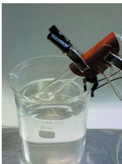
図4 シリコンラバーヒータでの可視化モデル
