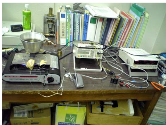
図3 充電実験の様子(発電機1機のみで充電成功)
